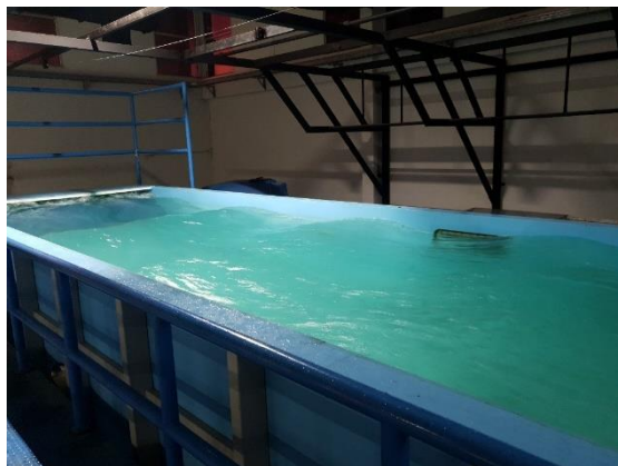
รูปที่ 10 ลักษณะการไหลของน้ำแบบราบเรียบ (Laminar flow)
